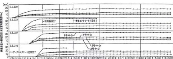
図-19 地下発電所の長期変位モニタリング例
