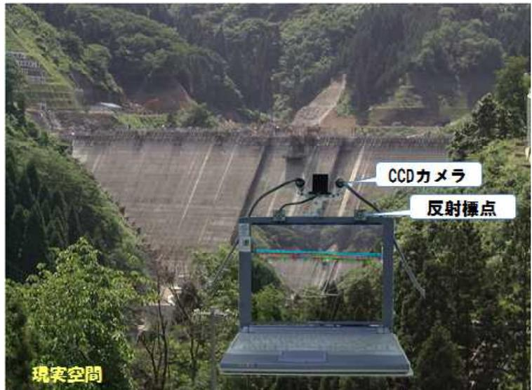
図-11 ビデオ・シースルー方式による AR システムの構成
